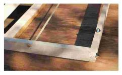
muss rechtwinklig erfolgen. Das ist besonders wichtig, weil die Wabe so hoch ist. Bitte beachten, dass die Seitenteile unten tiefer ausgefräst sind als oben. Nach der Montage sollte das Rähmchen auf eine ebene Fläche gelegt werden, um eine evtl. vorhandene "Windschiefheit" noch korrigieren zu können. Wenn der Leim getrocknet ist, lässt es sich nicht mehr verändern.
